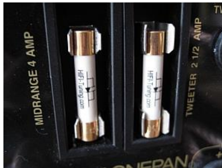
MAGNEPAN USA FAST FUSES 6,3 x 32 mm
